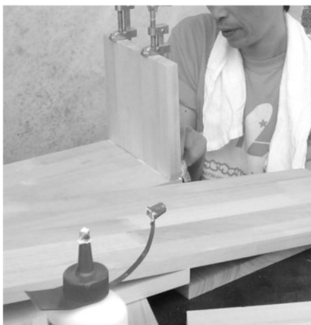
写真1 スピーカーボックスの接着
