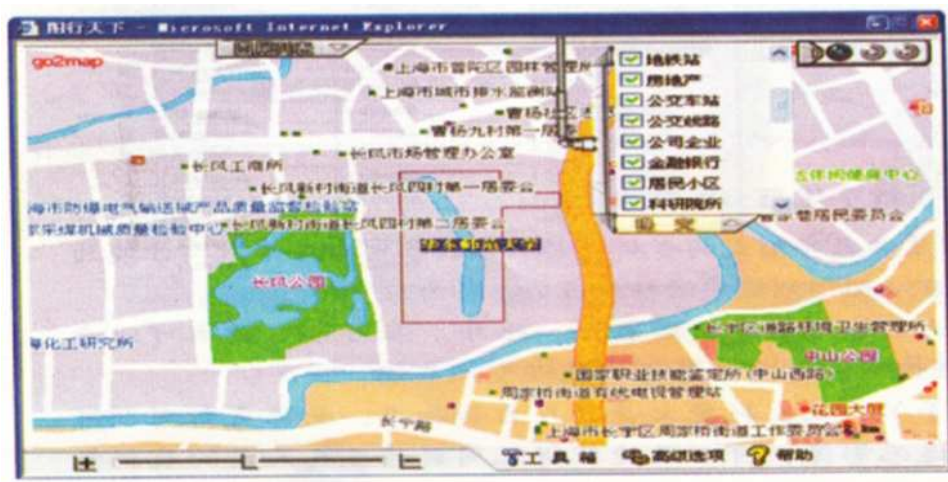
図VI-7 インターネット上の電子地図がレイヤ管理の方法を採用し、ユーザーが需要のレイヤを選択して表示、検索を行うことができる
