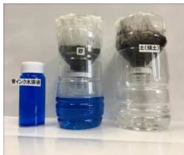
写真 5-5 青インク水溶液を土と砂に通過させた後の落水の色の比較
