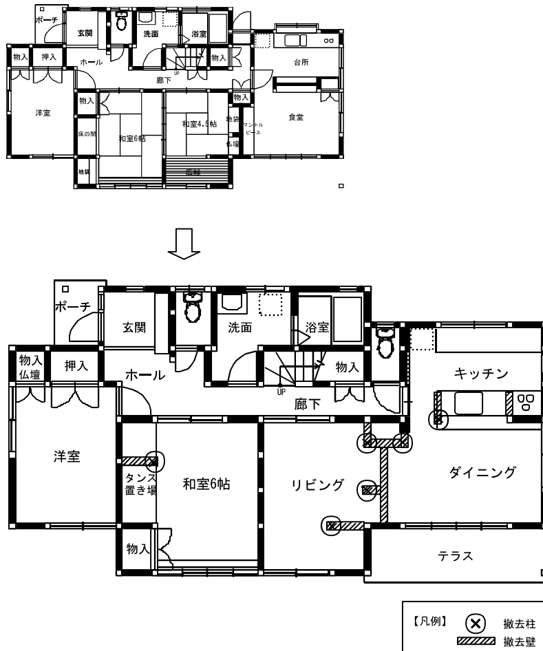
図 3-4-9 既存柱・壁撤去例（事例 No.3 第Ⅲ期→Ⅳ期）
