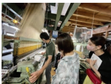
図6-3 ジャカード仕様のシャトル織機
