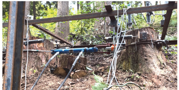
写真2 最大荷重 12.20kN 時
