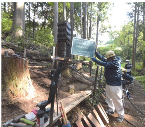
写真1 最大荷重 1,044kg (=10.23kN) 時
