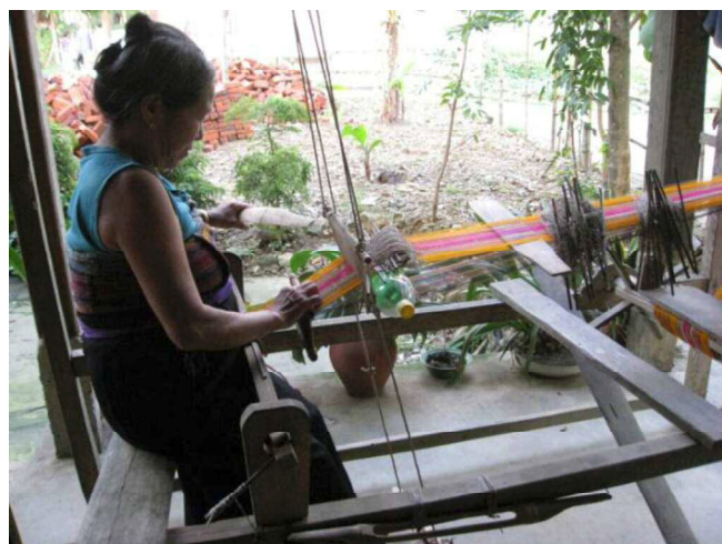
図 1-17 経浮紋織布 B を織る織機構造。綜紵一枚、中筒、紋綜紵が用いられている。ベトナム・ホアピン省にて筆者撮影。
