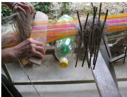
図 2-4 行程③。紋綜統の経糸を引き上げて刀杼で確保する。(2011 年 10 月ベトナム・ホアビン省 Lac 村にて筆者撮影)
