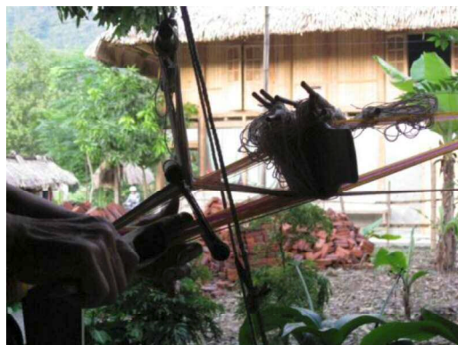
図 2-5 行程④。紋経と平経を同時に開口し緯糸を織りこむ。(2011 年 10 月ベトナム・ホアビン省 Lac 村にて筆者撮影)
