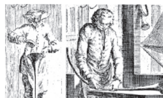
図 6 『百科全書』に描かれた、楽器用真鍮管への鉛の流し込み (左) と湾曲 (右)
