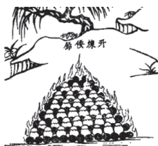
図4 『天工開物』に描かれた亜鉛の製法：炉甘石を密封した坩堝を燃焼させる。
