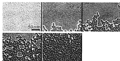
Fig. 3 1wt% を 76^\circ\text{C} に温度ジャンプして得られた位相差顕微鏡観察の様子。それぞれ左上から温度ジャンプ後 10min, 55min, 58min, 62min, 70min のパターンを示す。
