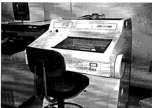
本装置の中でも最も利用頻度の高いユングクライオカット3000IV。主に動物組織の凍結切片作成に用いられている。
